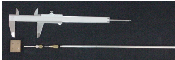
Figura 2 - Montagem mecânica para encapsulamento do sensor (paquímetro aberto em 5 cm).
