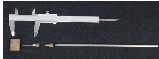
Fig. 5. Montagem mecânica para encapsulamento do sensor (Paquímetro aberto em 5 cm).
